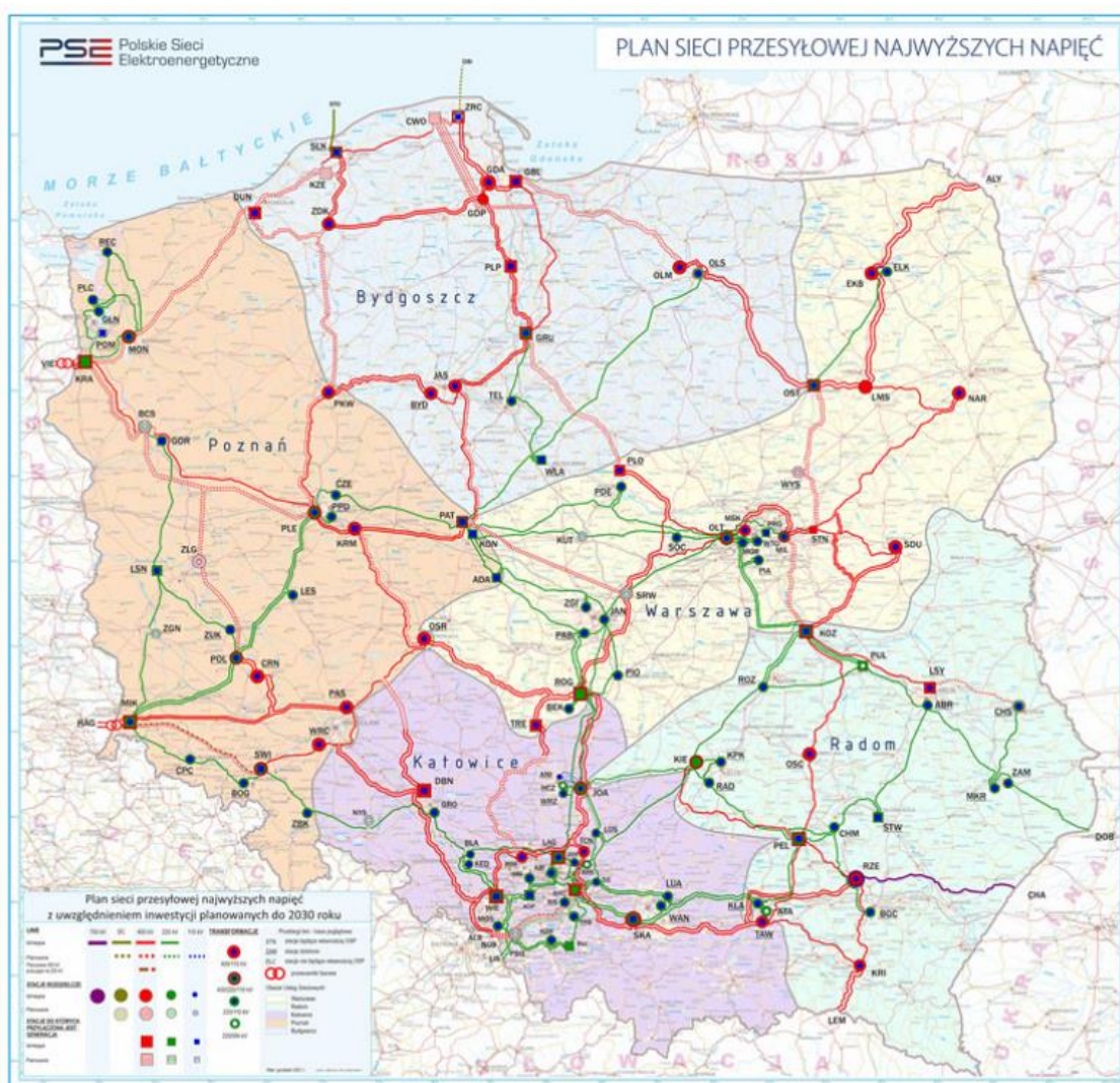
Rysunek 1. Schemat Krajowego Systemu Przesyłowego (KSE)
